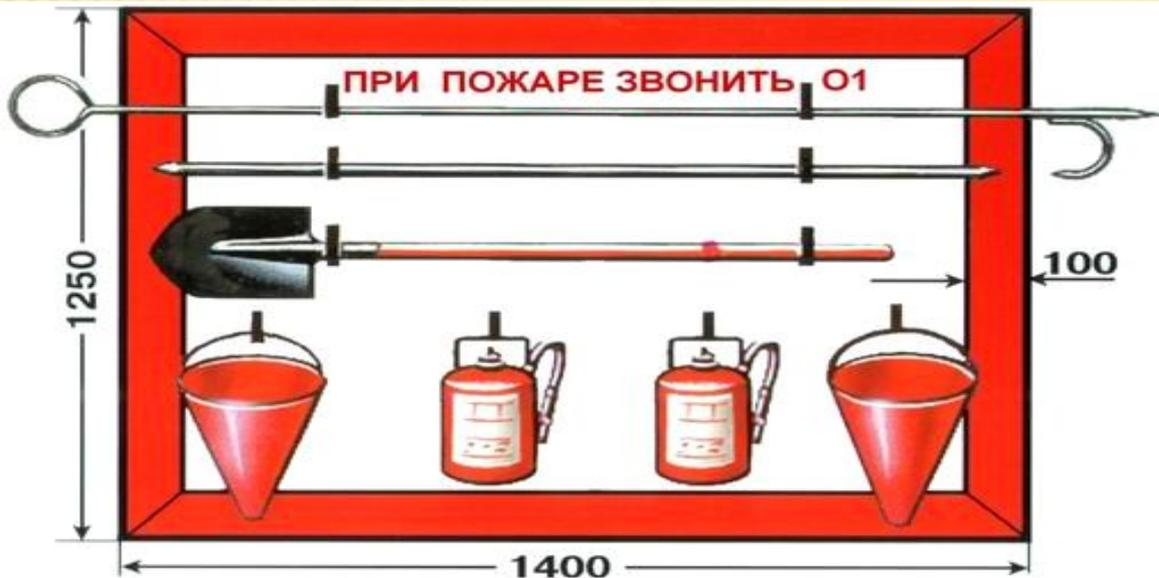
**ПРЕДНАЗНАЧЕН** для размещения первичных средств пожаротушения, немеханизированного инструмента и пожарного инвентаря в производственных и складских помещениях, не оборудованных противопожарным водопроводом и автоматическими установками пожаротушения, а также на территории предприятий, не имеющих наружного противопожарного водопровода, или при удалении зданий (сооружений), наружных технологических установок на расстояние более 100 м от наружных пожарных водосточников.
