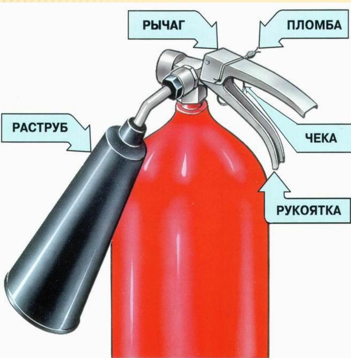
Углекислотные огнетушители предназначены для тушения загораний различных веществ и материалов, а также электроустановок, кабелей и проводов, находящихся под напряжением до 1000В
