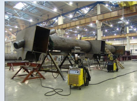
Дуговая сварка плавящимся электродом в среде защитных газов Aristo LUD (ESAB), Phoenix 400 (EWM), Fastmig 450 (Kemppi)
