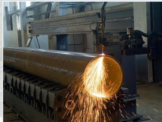
Роботизированная установка газокислородной резки труб PCM-CP1220
