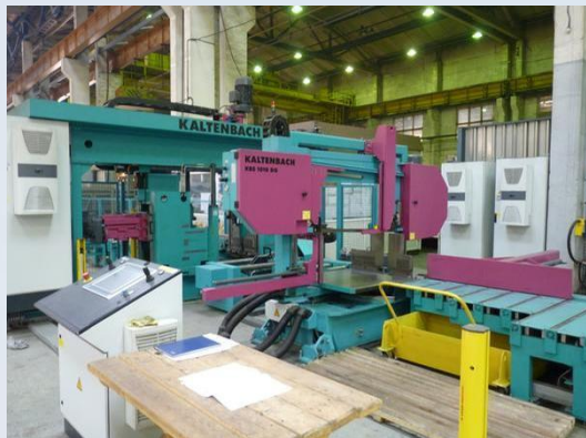
Установка для сверления и механической резки фасонного и листового проката «Kaltenbach», Германия
