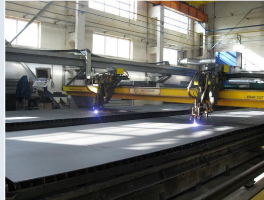
Машины плазменной резки Suprarex SXE-8000, ESAB, Messer, MultiTherm HPR-3600, Bach, MultiCut ACBP 2500,
