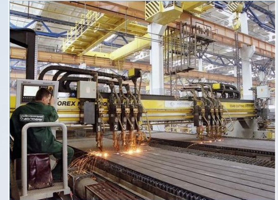
Машина газокислородной резки Numorex NXB 8500, ESAB
