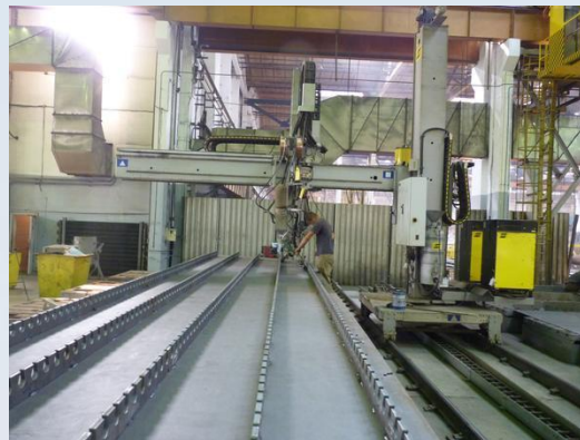
Установки автоматической дуговой сварки под флюсом САВ460, САВ300, Mechtrac 3000, A6 Mastertrac, IT 258, A2 Multitrac (ESAB), Noboruder (Koyke)
