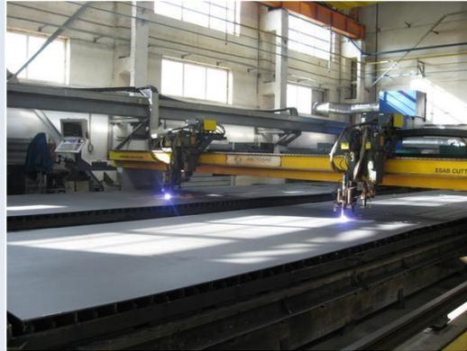
**Машины плазменной резки**
