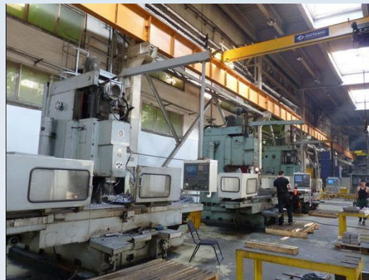
Вертикально-фрезерные станки 65А60Ф1-11, 6М612Ф4, Россия
