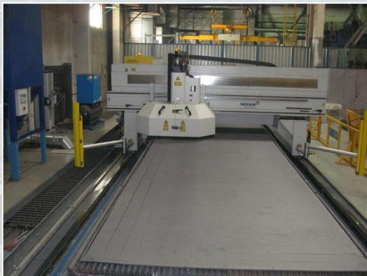
Машина лазерной резки LaserMat 4200, Messer
