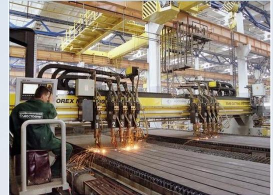
**Машина газокислородной резки**
