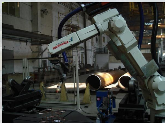
Робото-технологический комплекс Kawasaki FA006E, Nordica Sterling
