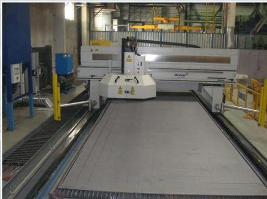
**Машина лазерной резки**
