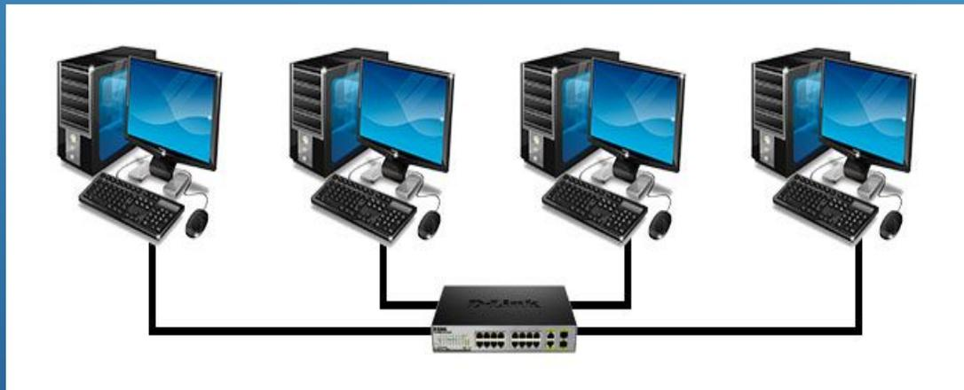
**Соединение типа «звезда».**
