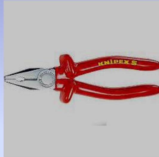
**Ещё больше разница между длиной ручек и расстоянием режущей части от оси вращения в кусачках. Они предназначены для перекусывания проволоки, не очень толстых гвоздей.**
