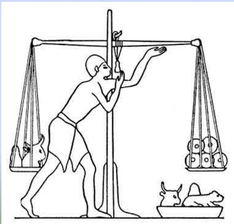
На принципе рычага основано действие рычажных весов. Все весы, изображённые на рисунках, действуют как равноплечий рычаг, т.е. вес груза на одной чаше равен весу гирь на другой чаше.
