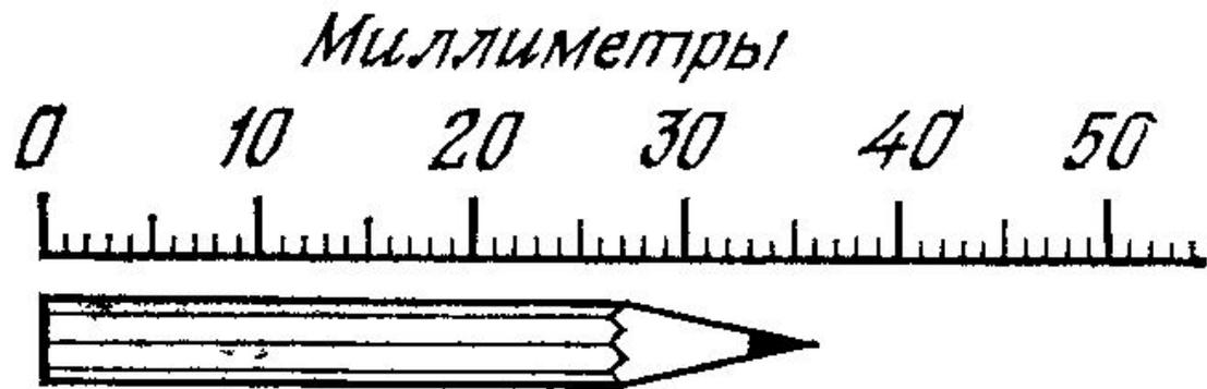
Измерение длины линейкой.
