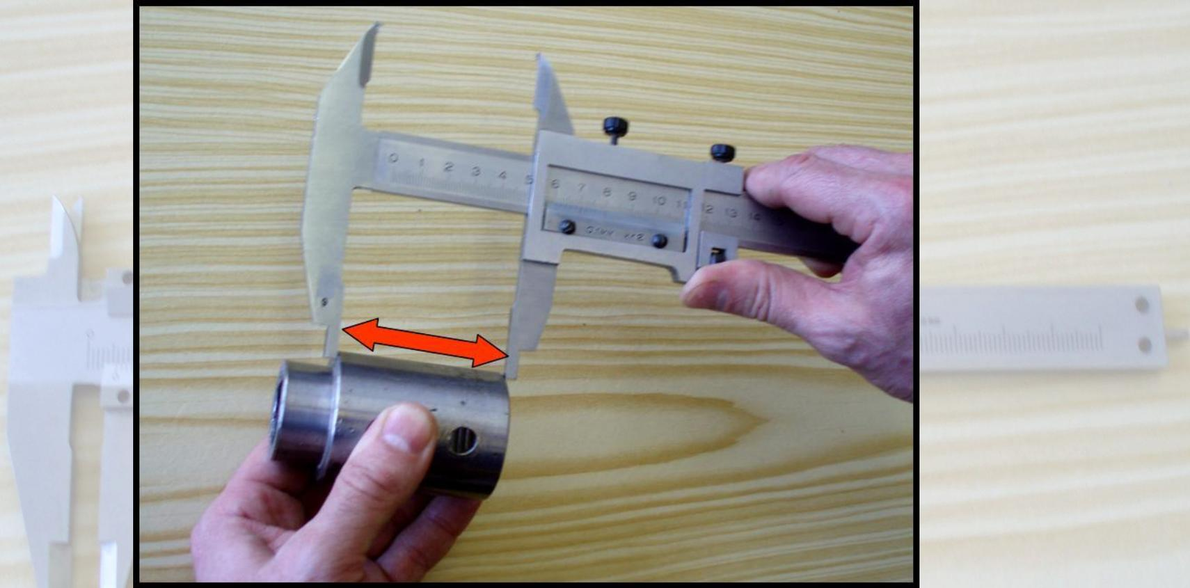
При измерении наружного размера штангенциркуль берут в правую руку и ослабляют зажимной винт рамки, затем разводят измерительные губки на размер, несколько больший размера измеряемой детали, помещают деталь между губками и передвигают рамку до соприкосновения губок с поверхностью детали. Измеряя деталь, закрепляют рамку зажимным винтом и вынимают деталь из промежутка между губками штангенциркуля. Держа штангенциркуль прямо перед глазами, считывают результат.
