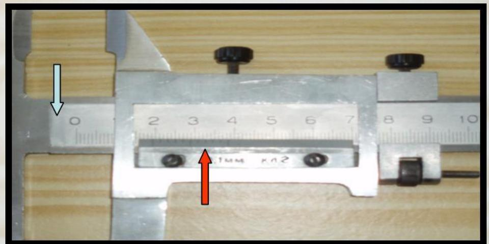
Перед началом работы штангенциркуль протрите чистой мягкой тканью, удаляя смазку и пыль (тщательно очищают измерительные поверхности губок).
