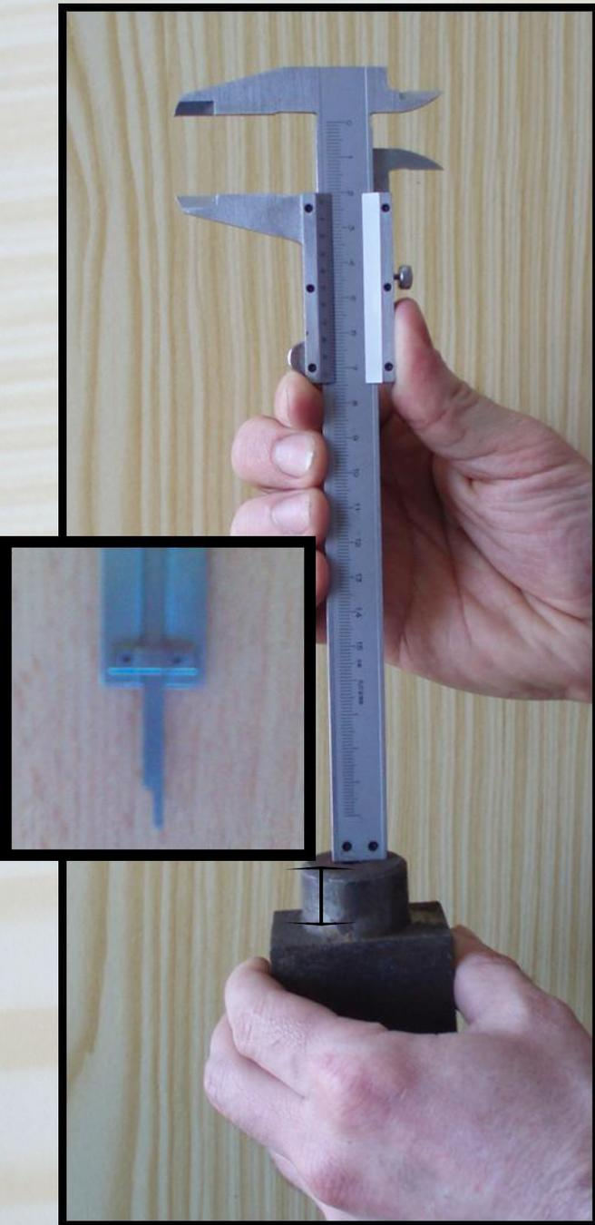
Глубину пазов и отверстий, а также высоту различных уступов деталей измеряют с помощью глубинометра — специального устройства, имеющегося у штангенциркуля. Взяв штангенциркуль в правую руку и ослабив зажимной винт рамки, упирают торец штанги в верхний край измеряемого углубления. Перемещая подвижную рамку, вводят линейку глубинометра в отверстие или другое углубление до упора, закрепляют это положение рамки зажимным винтом, вынимают глубинометр из углубления и считывают результат измерения.
