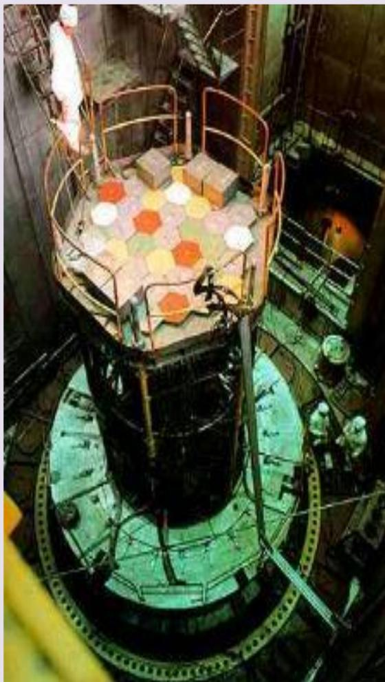
Реактор атомного ледокола «Арктика».
