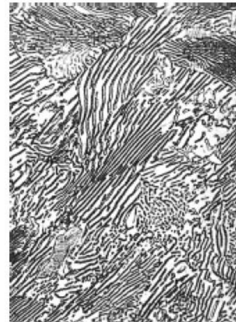
Bild 4.0.5 Gefüge von Perlit
