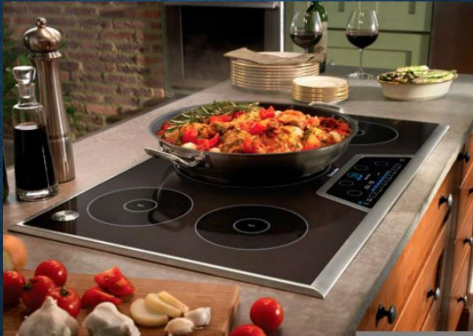
Кухонная электрическая плита, разогревающая металлическую посуду индуцированными вихревыми токами, создаваемыми высокочастотным магнитным полем частотой 20–100 кГц.
