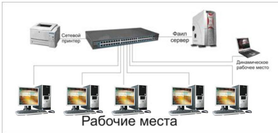
Выделенным называется такой сервер, который функционирует только как сервер (исключая функции клиента или рабочей станции).
