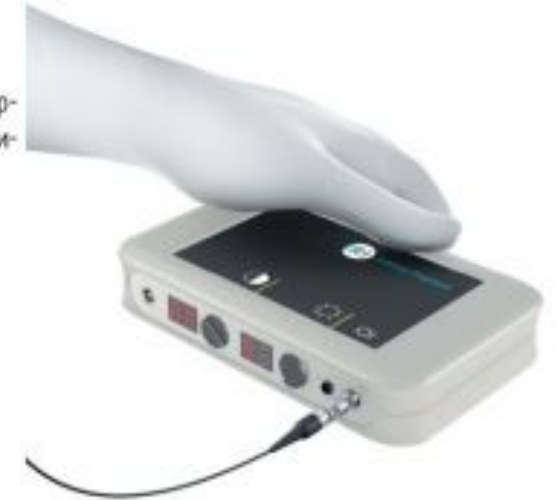
Рис. 4. Электропитание имплантата. Пациент может сделать простые настройки самостоятельно (например, контраст)
