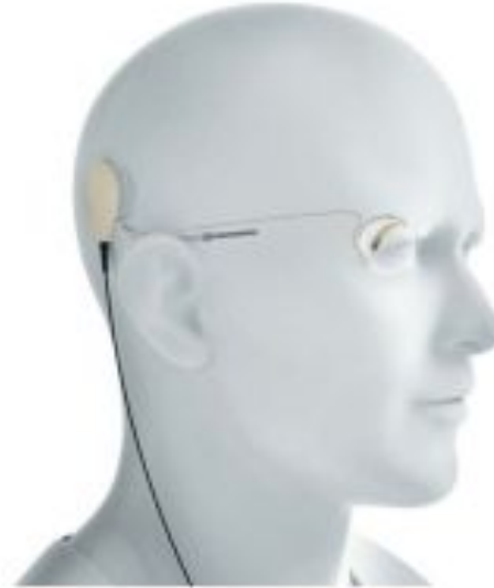
Рис. 3. Чип получает дополнительную энергию через кожу с помощью внешнего источника питания
