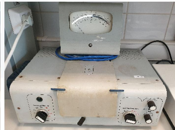
*Аппарат для колориметрического определения*
