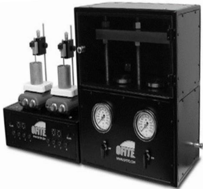
Установка оценки гидрофобизаторов по ингибирования гидратации глин
