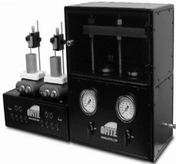
Установка оценки гидрофобизаторов по ингибирования гидратации глин
