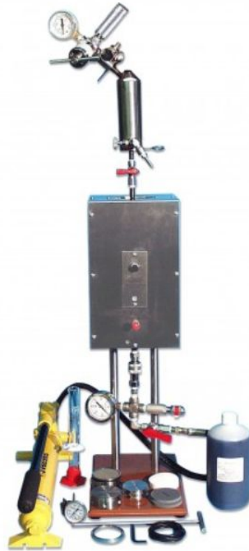
Тестер проницаемости на керамических или металлических дисках
