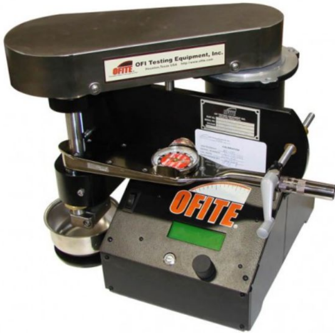
Тест смазывающей способности
