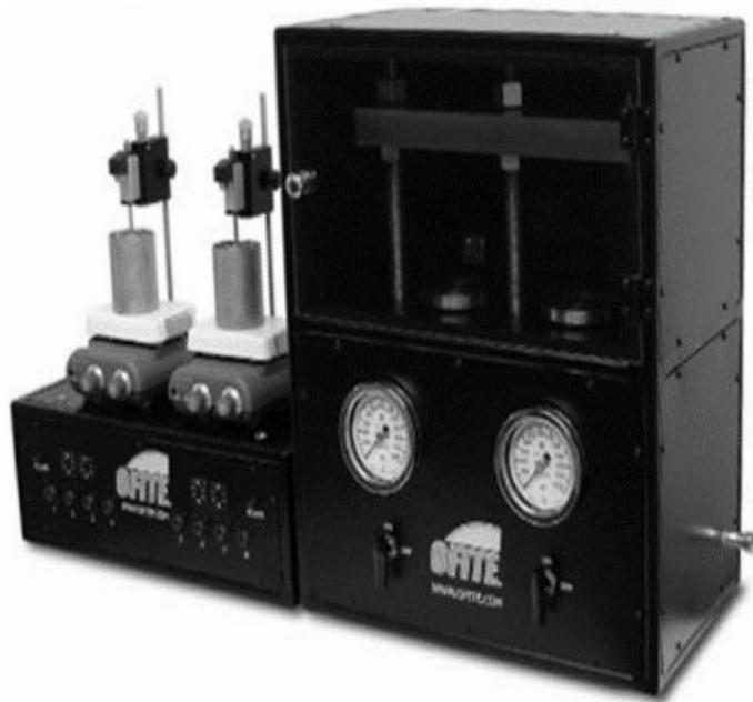
*Установка оценки гидрофобизаторов по ингибирования гидратации глин*
