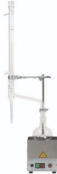
*Аппарат для количественного определения воды в нефтепродуктах*
