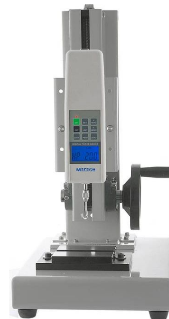
Испытательный динамометрический стенд для измерения прочности гелей (Мегзон 03000D)
