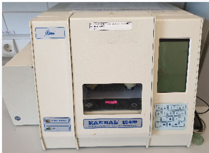
Установка капиллярного электрофореза для анализа содержания ионов в водах
