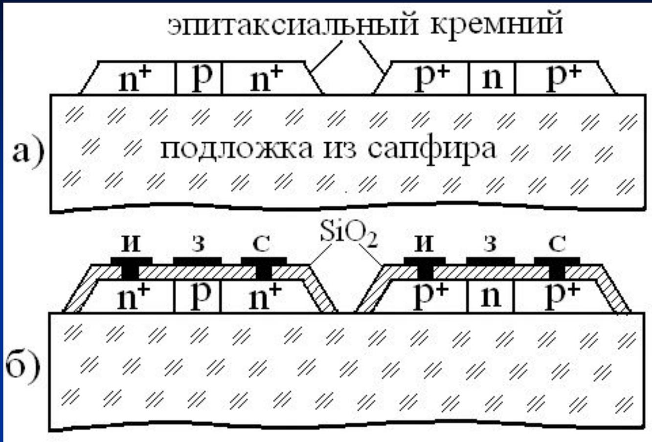
а) Изолированные островки монокристаллического Si со сформированными областями n- и p-типа.
