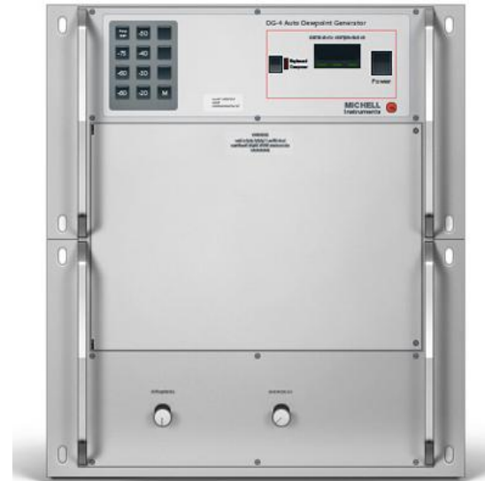
Рисунок 3. Генератор влажного газа Michel Instruments, модификации DG-4
