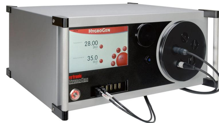
*Рисунок 5. Генератор влажного воздуха HygroGen*
