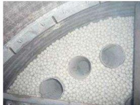
Рисунок 6. Двухсекционный реактор гидроочистки дизельного топлива
