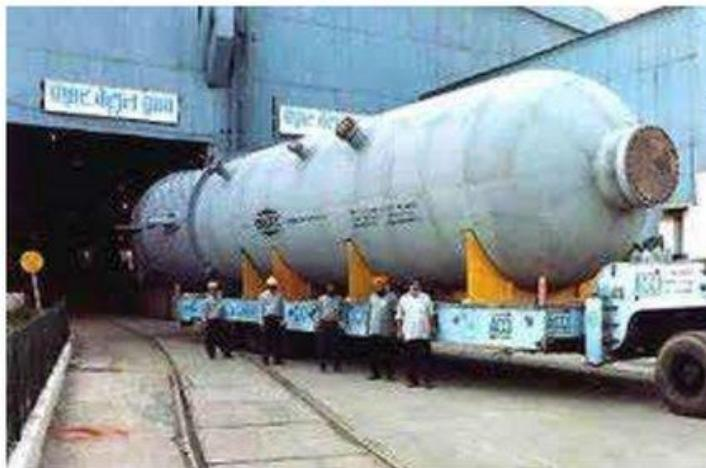
Рисунок 8. 130-ти тонный реактор гидроочистки дизельного топлива
