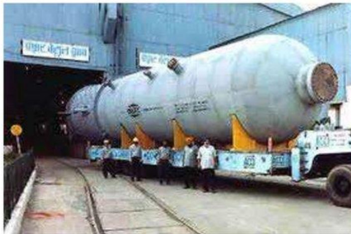
Рисунок 8. 130-ти тонный реактор гидроочистки дизельного топлива
