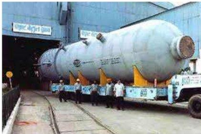
Рисунок 8. 130-ти тонный реактор гидроочистки дизельного топлива
