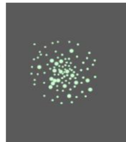
Фотографии люминесцирующего экрана при отсутствии золотой фольги в потоке \alpha - частиц и при ее внесении в поток
