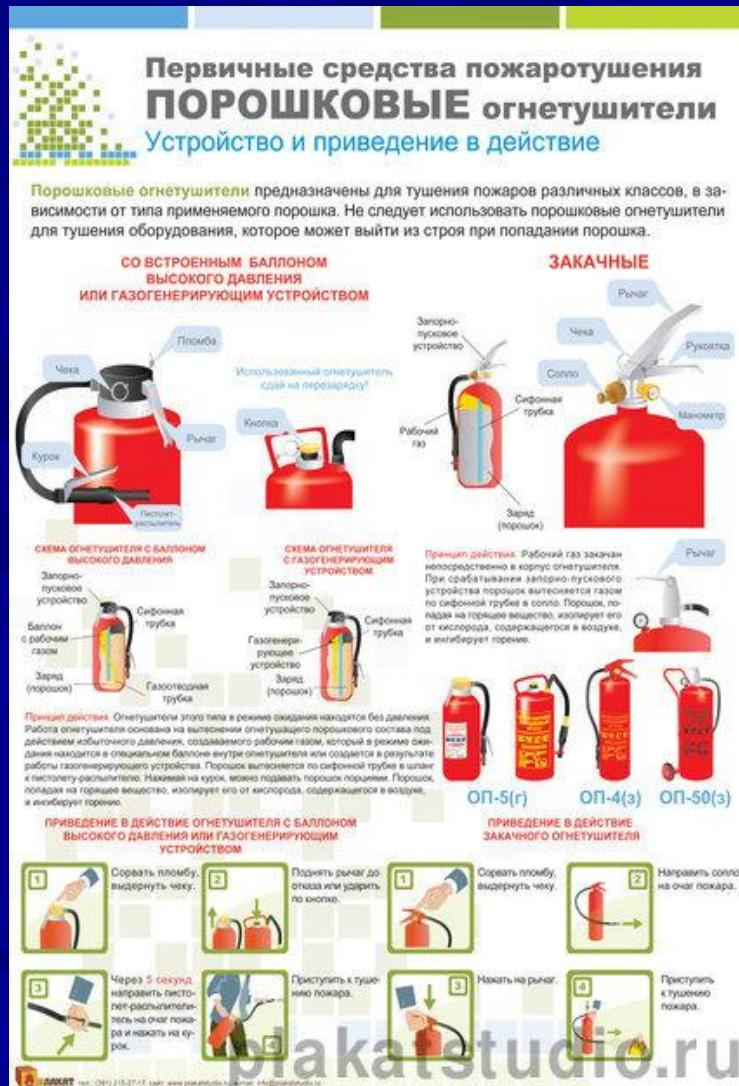
При постановке огнетушителей в эксплуатацию они должны быть заряжены, опломбированы и иметь бирку с указанием даты (месяц, год) зарядки и даты очередной перезарядки и технического освидетельствования.
