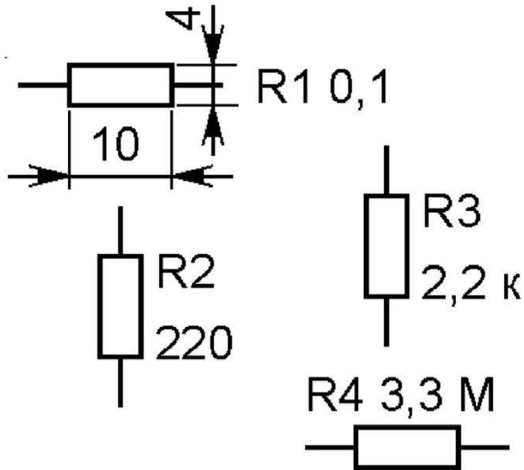
Указанные на рисунке размеры УГО резисторов установлены ГОСТ 2.728–74 и их следует соблюдать при вычерчивании схем.
