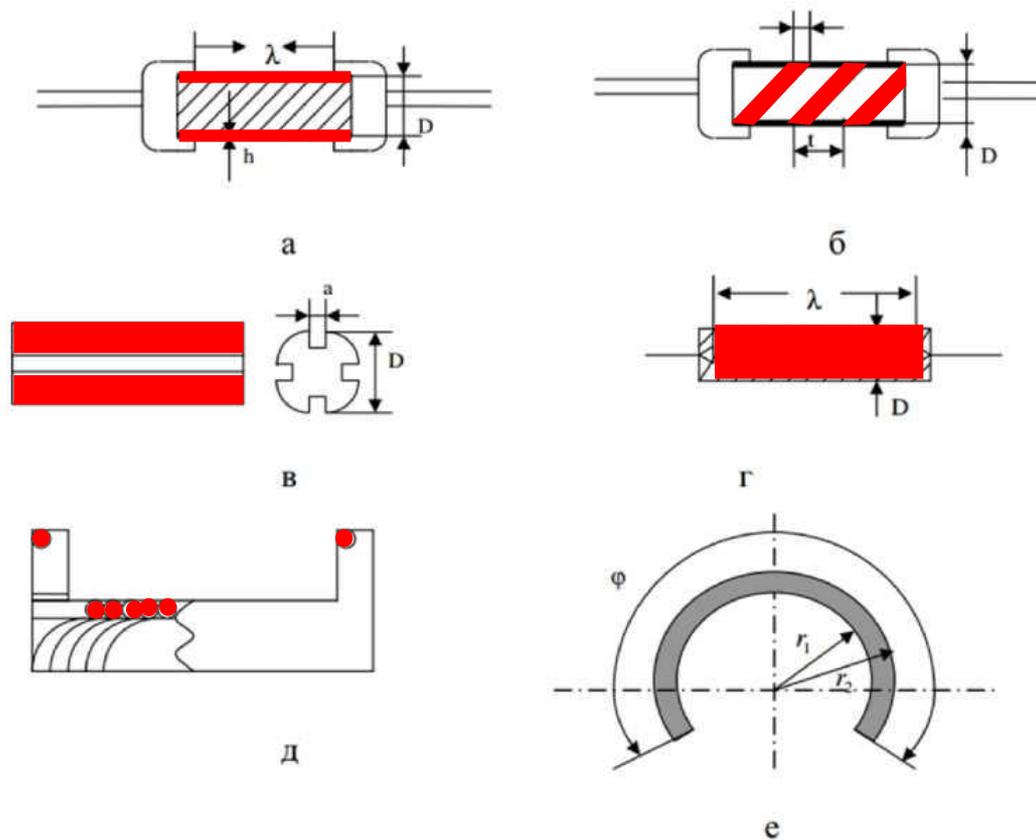
а - резистор цилиндрической формы с проводящим элементом, нанесенным на изоляционную поверхность; б - резистор цилиндрической формы со спиральной нарезкой проводящего элемента; в - резистор цилиндрической формы с прорезанными изолирующими канавками; г - резистор объемной конструкции; д - проволочный резистор; е - резисторы с подковообразным проводящим элементом.
