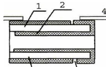
**Рулонная конструкция** характерна для бумажных пленочных низкочастотных конденсаторов, обладающих большой емкостью.
