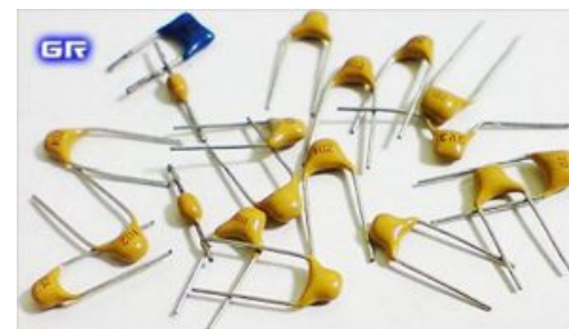
Керамические конденсаторы с нанесенной маркировкой емкости числовым кодом
