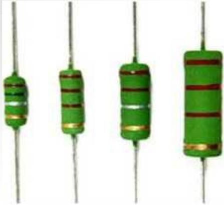
Применяются в качестве нагрузок усилительных каскадов, делителей напряжения, в фильтрах цепей питания, добавочных сопротивлений и шунтов измерительных цепей и т. д. Они являются изделиями массового производства и стандартизованы.
