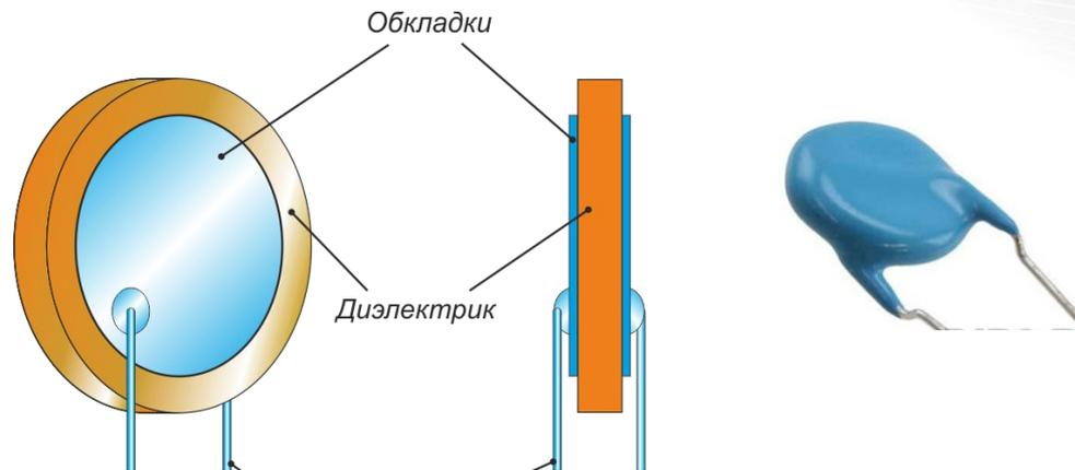
**Пленочные конденсаторы** применяют принцип «многослойности», т. е. создают много слоев диэлектрика, чередующегося слоями обкладок. Различают два вида пленочных конденсаторов – **радиальные** и **аксиальные**. Диапазон емкости - от 5пФ до 100мФ. Диапазон номинального напряжения - более 2000В.
