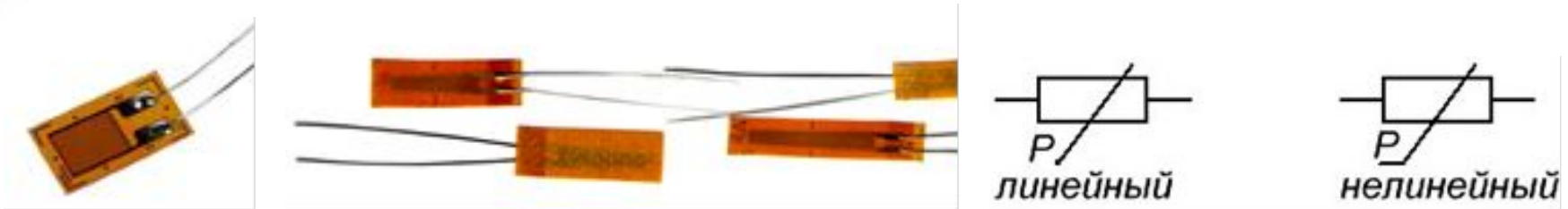
Внешний вид и УГО тензорезистора.
