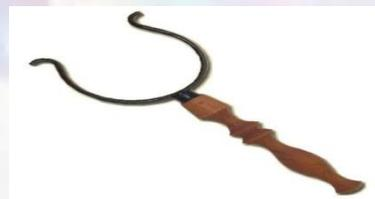
4. Ухват (с его помощью ставят и достают из печи чугунок).
