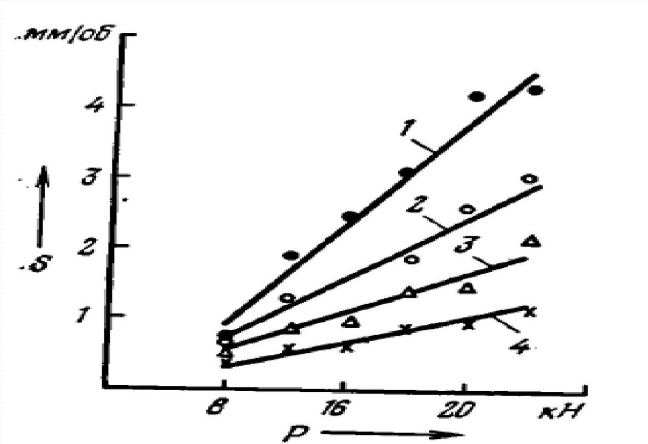
Рисунок 7.3 – Зависимость подачи инструмента от усилия подачи  $P$  и частоты вращения  $n$ :
