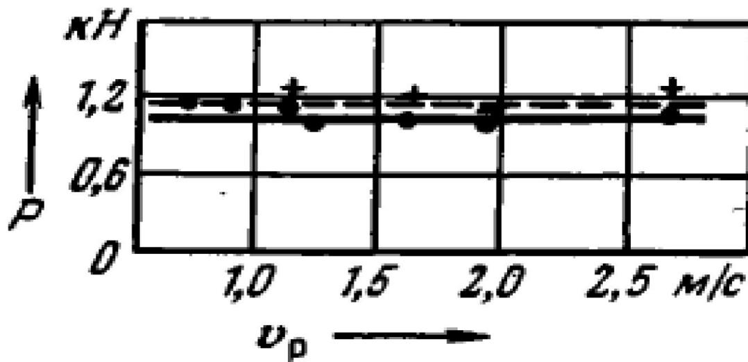
Рисунок 7.4 – Зависимость усилия резания  $P_z$  и усилия подачи  $P_y$  от скорости резания  $v_p$  (известняк  $P_k = 1130$  Мпа,  $a = 1,4$  мг)
