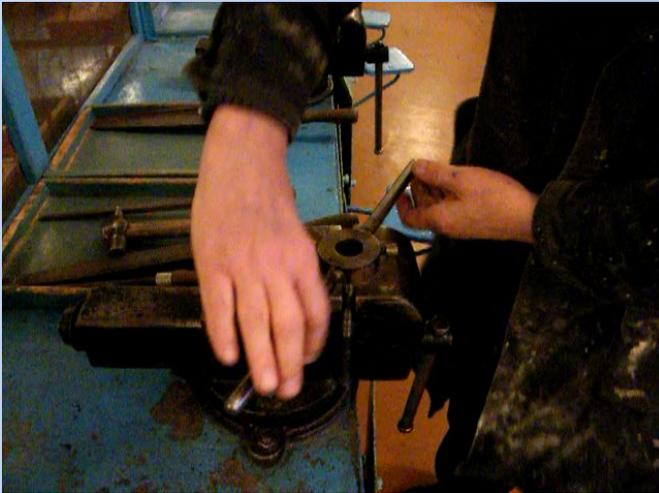
Внутреннюю резьбу нарезают метчиками, которые состоят из хвостовика и рабочей части .
