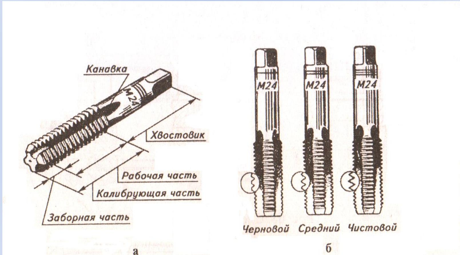
Метчики: а-устройство; б-комплект для нарезания метрической резьбы
