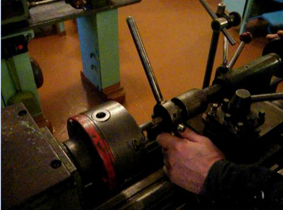
**Поджимает плашкодержатель центром и включаем станок.**
