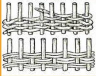
Наиболее распространено простое плетение. В некоторых случаях, чтобы ускорить процесс, его выполняют сразу двумя-тремя рядами. Хотя простое плетение выполняется довольно быстро и легко, прочность его не высока.
