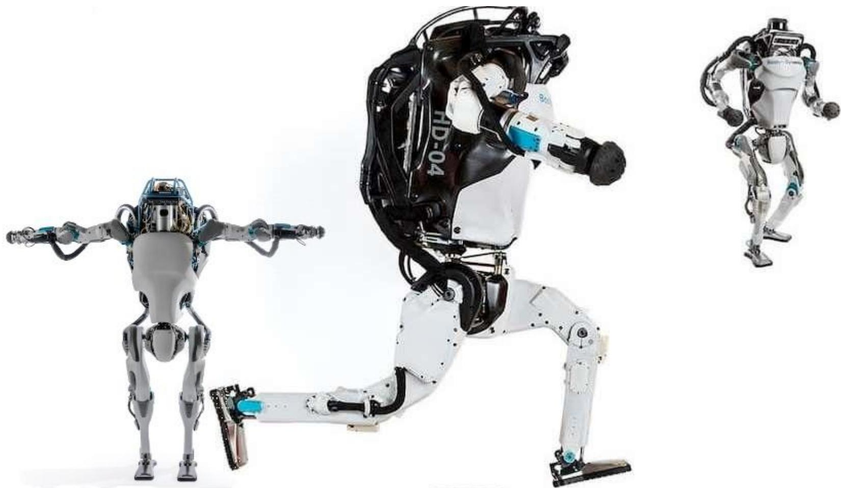
**Atlas** основан на более ранней версии Boston Dynamics PetMan робот-гуманоид, и подсвечивается синим Светодиоды. **Atlas** оснащен двумя системами видения – лазерной дальномер и стереокамеры, оба управляются бортовым компьютером – и имеют руки с мелкая моторика возможности. Его конечности обладают в общей сложности 28 степеней свободы. **Atlas** может перемещаться по пересеченной местности и самостоятельно подниматься, используя.
