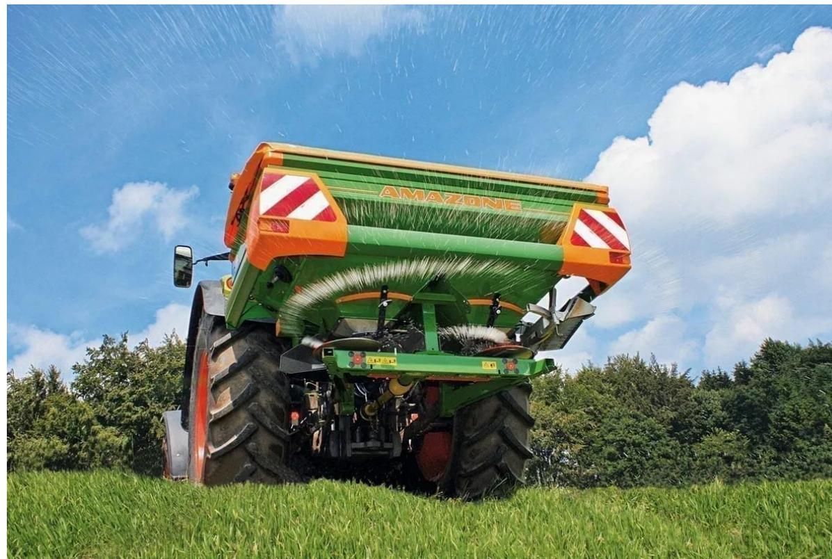
Двухдисковый распределитель удобрений. Бункер до 3.000 л Ширина захвата 36 м
