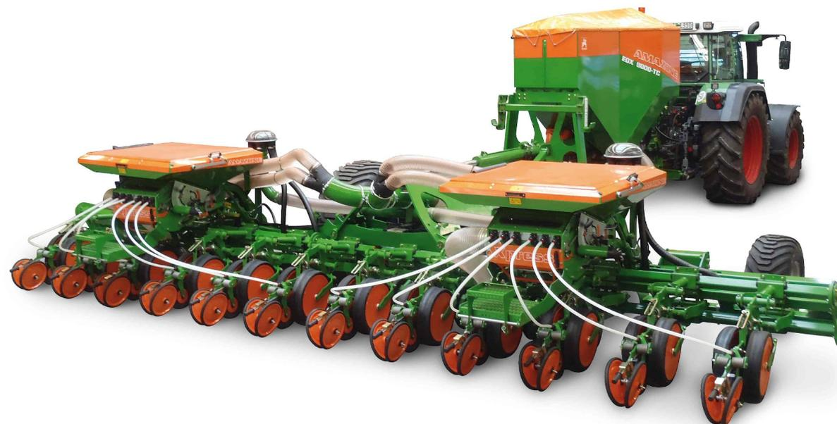
Сялка точного высева . Ширина захвата 6, 9 и 12м. объем Бункера 600 и 800 л. Скорость до 15 км/ч
