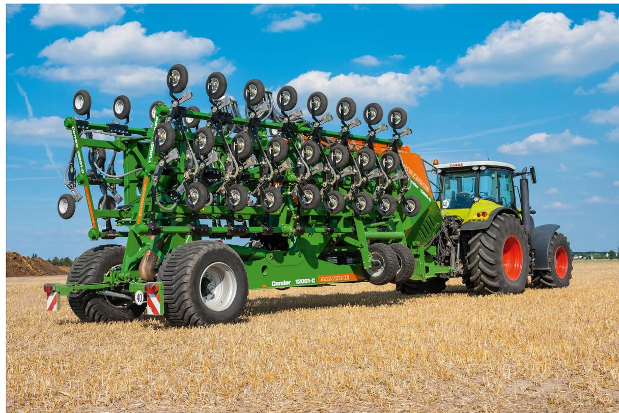
Прицепная сеялка выполняет работу выевающими сошниками Contec pro. Ширина захвата 12 и 15 м. Бункер 8000 л
