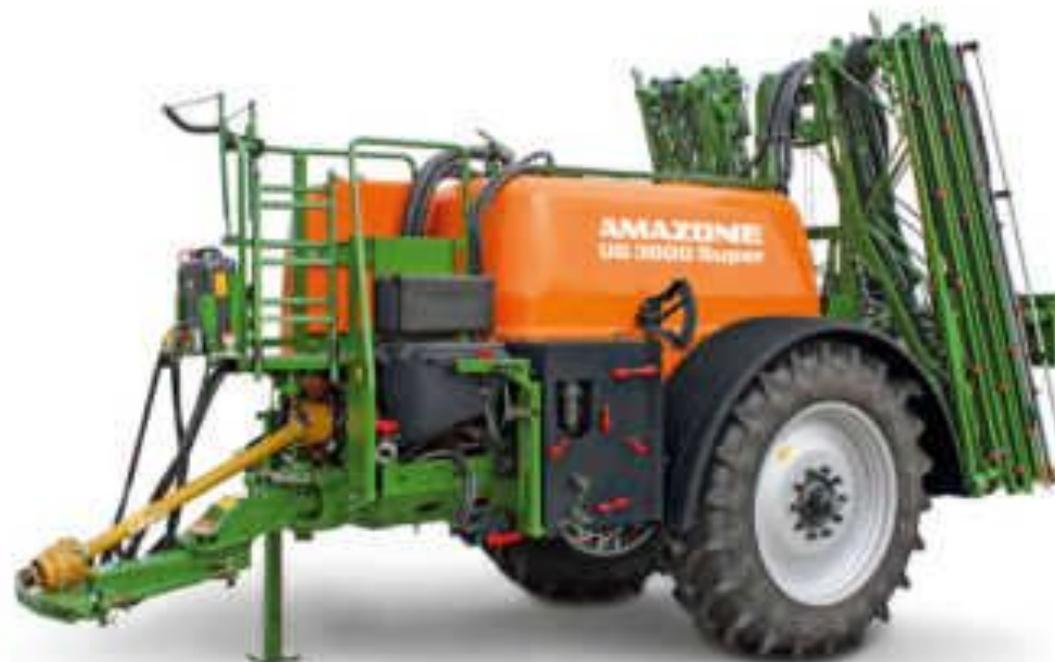
Прицепной опрыскиватель . Объем бака 2.200 и 3.300 л Ширина захвата от 15 до 28 м
