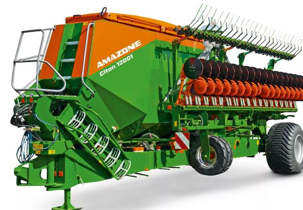
Пневматическая сеялка прицепная. Ширина захвата от 8 м до 15 м Объем бункера 4.600 и 8.000 л
