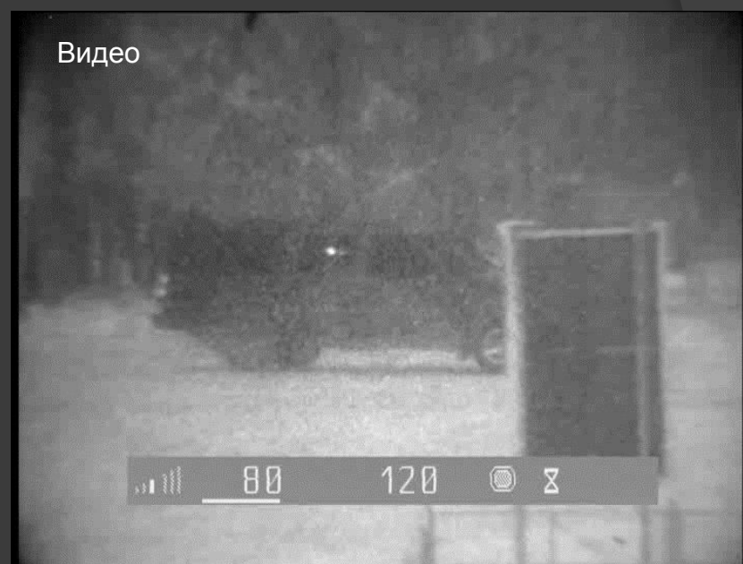
Обнаружение наблюдения биноклем из-за тонированного стекла автомобиля
