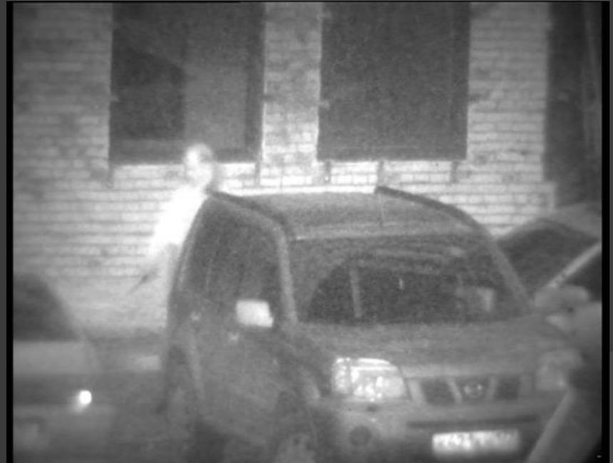
Изображение, полученное с помощью активно-импульсного прибора
