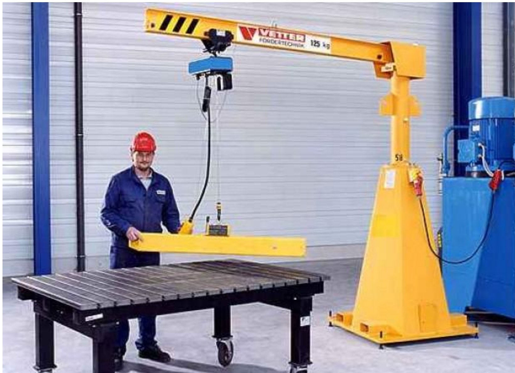
Консольный кран на колонне.
