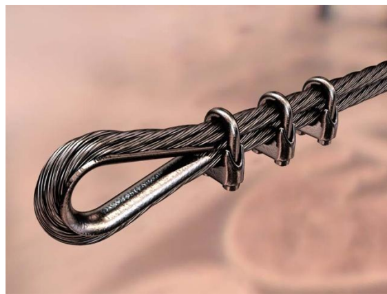
Рис. 12.5. Канатные стропы: 1 — канат; 2 — коуш; 3 — винтовой эжим
