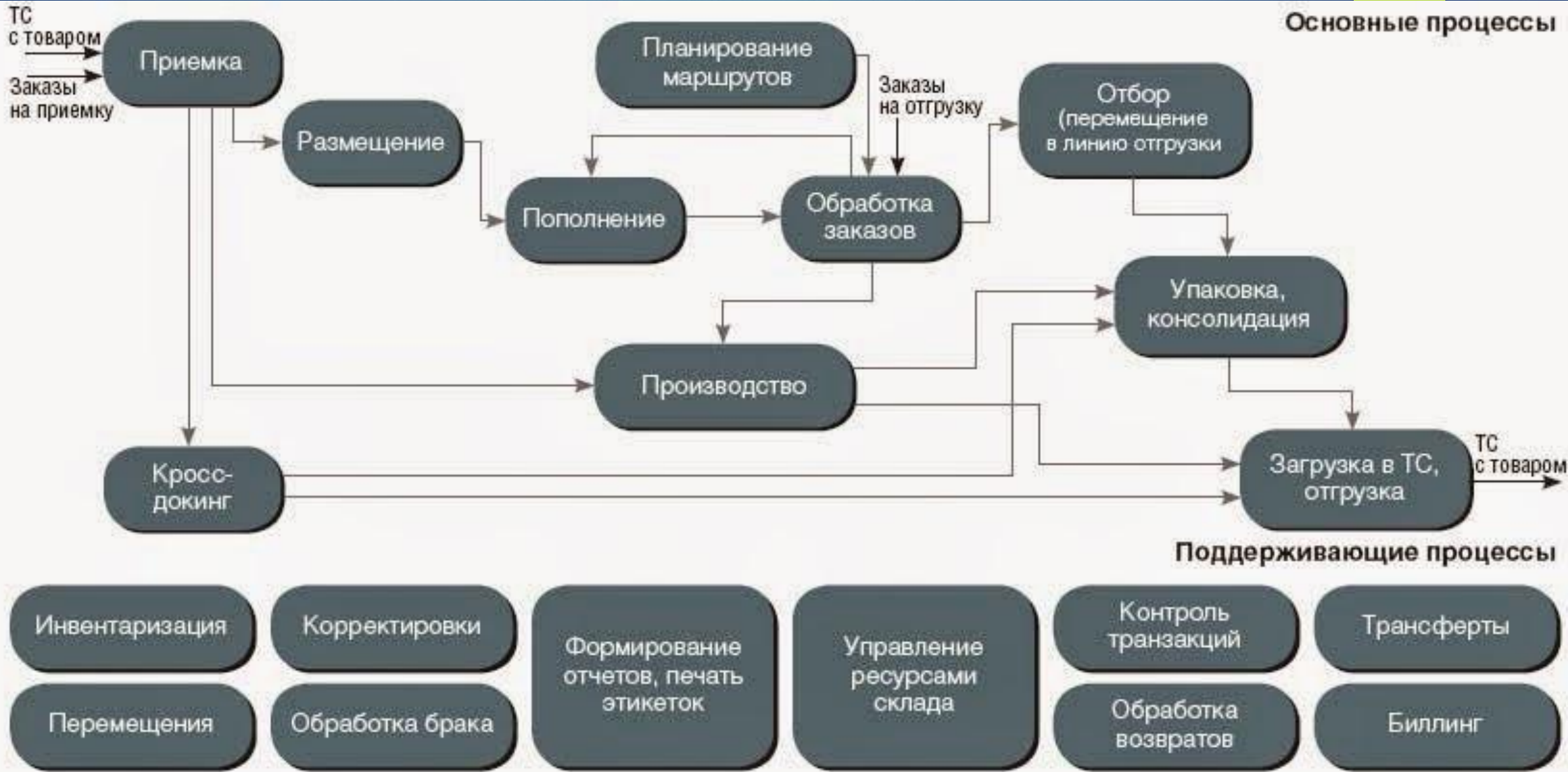
Рис. 2. Общая схема процессов на складе
