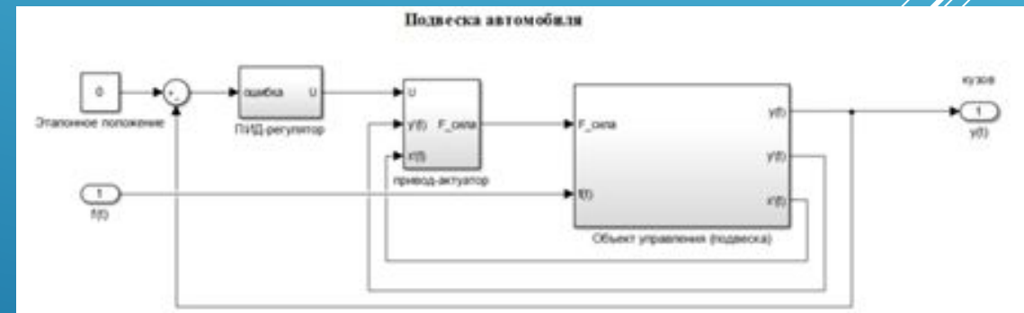
Математическая модель ПИД - регулятора
