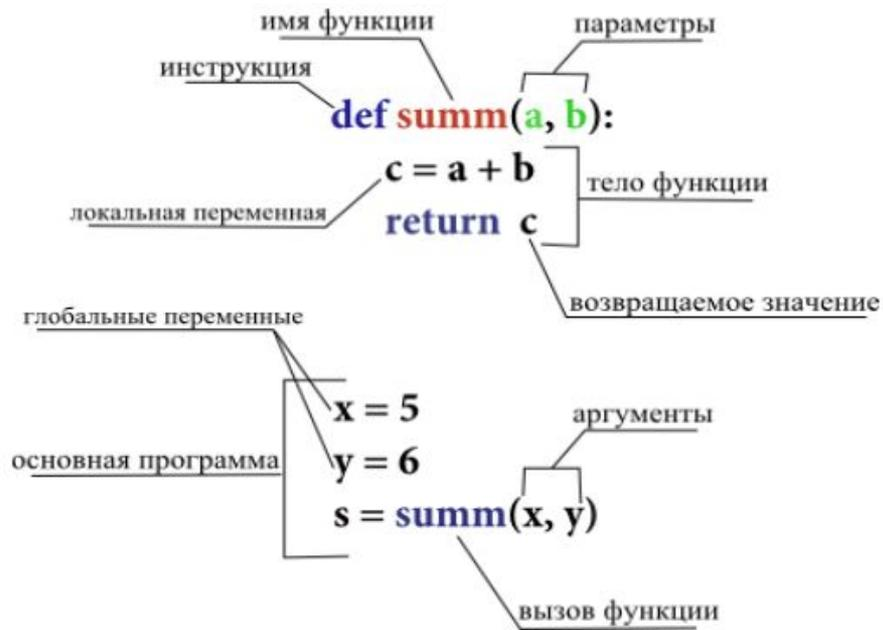
Рис. Схема и термины функции
