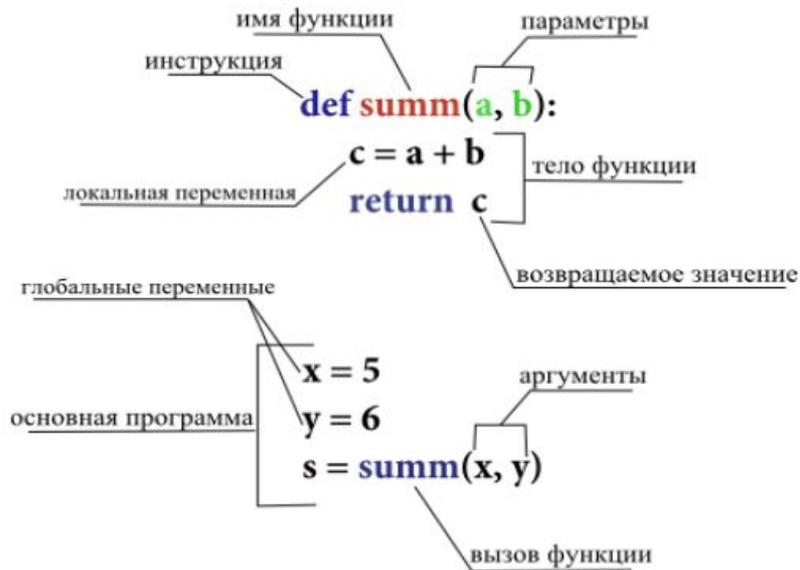
Рис. Схема и термины функции
