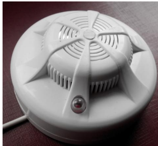
ИП 435-55-1Д (оксид углерода \text{CO} )
