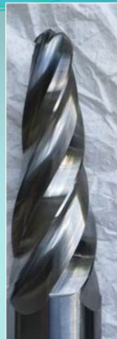
Производительность твердосплавной фрезы из сплава BK10XOM с различными вариантами покрытий
