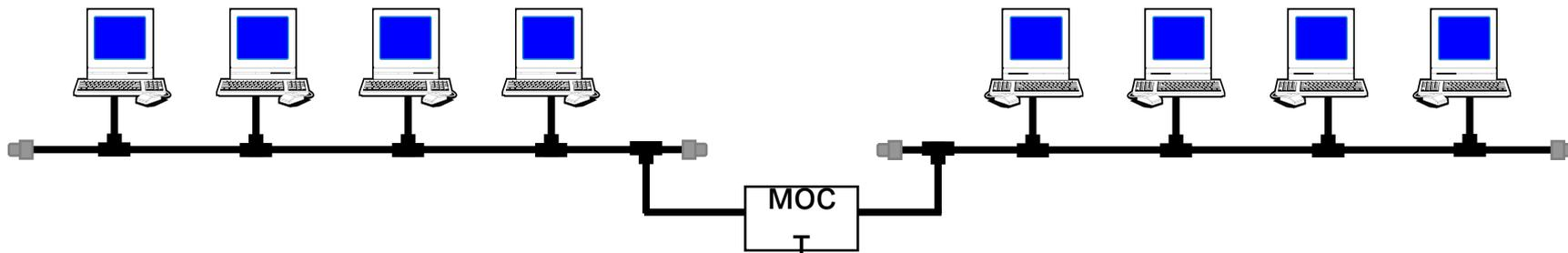
Вариант: компьютер с двумя сетевыми картами.
