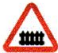
1.1 Железнодорожный переезд со шлагбаумом
