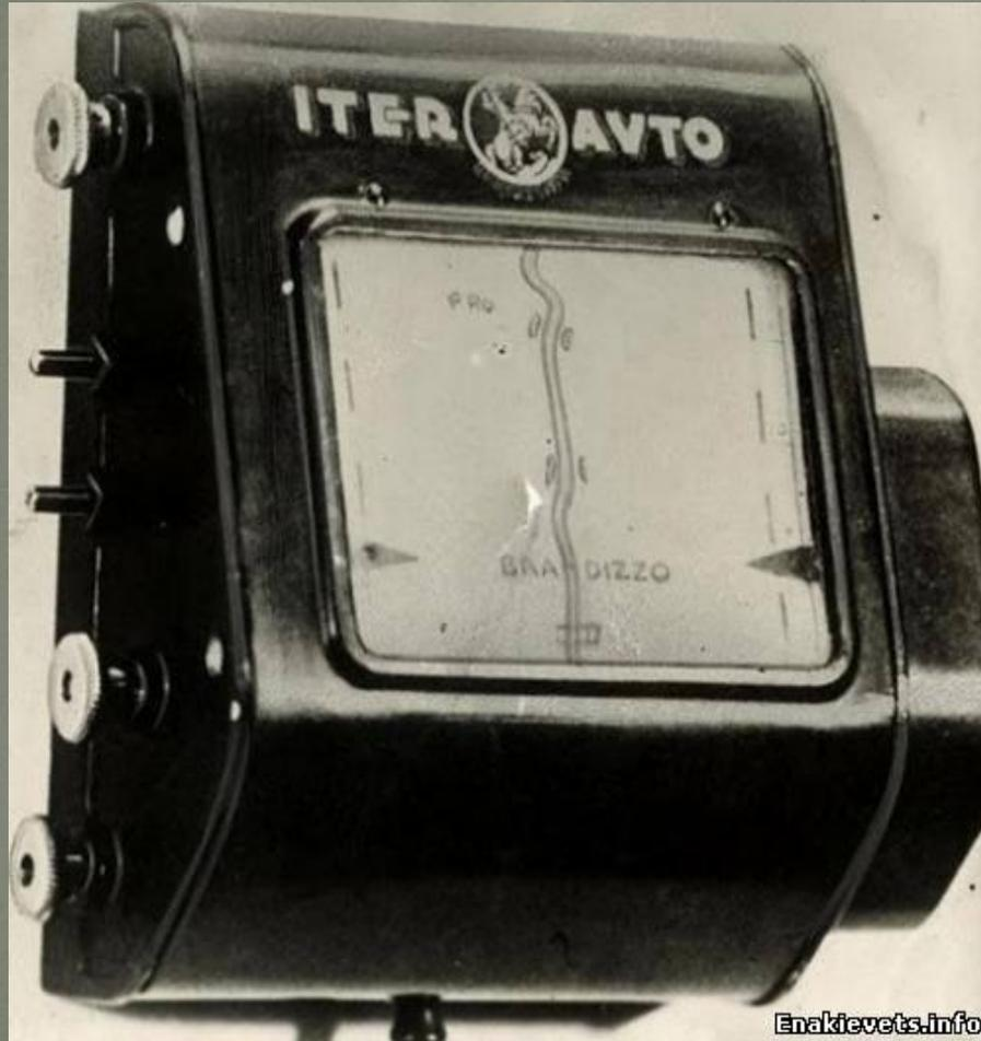
Когда-то необычное изобретение, аналог "GPS-навигатора" образца 1932 с прокручивающейся картой, скорость прокрутки зависит от скорости автомобиля
