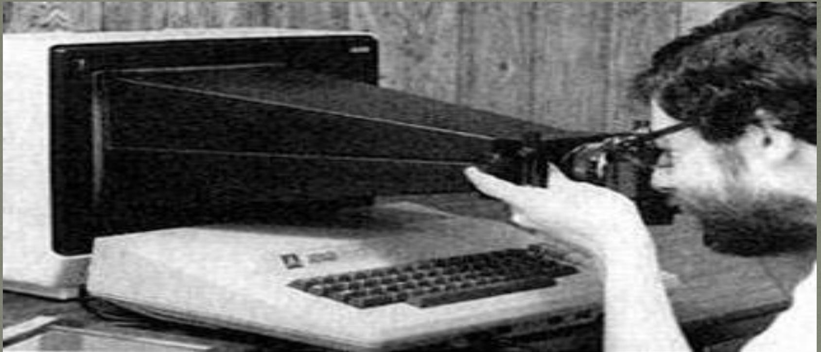
Так снимок с экрана компьютера (скриншот) делали в начале 1980-х: фотокамеру Polaroid соединяли с монитором ATARI 800 специальным растробом.
