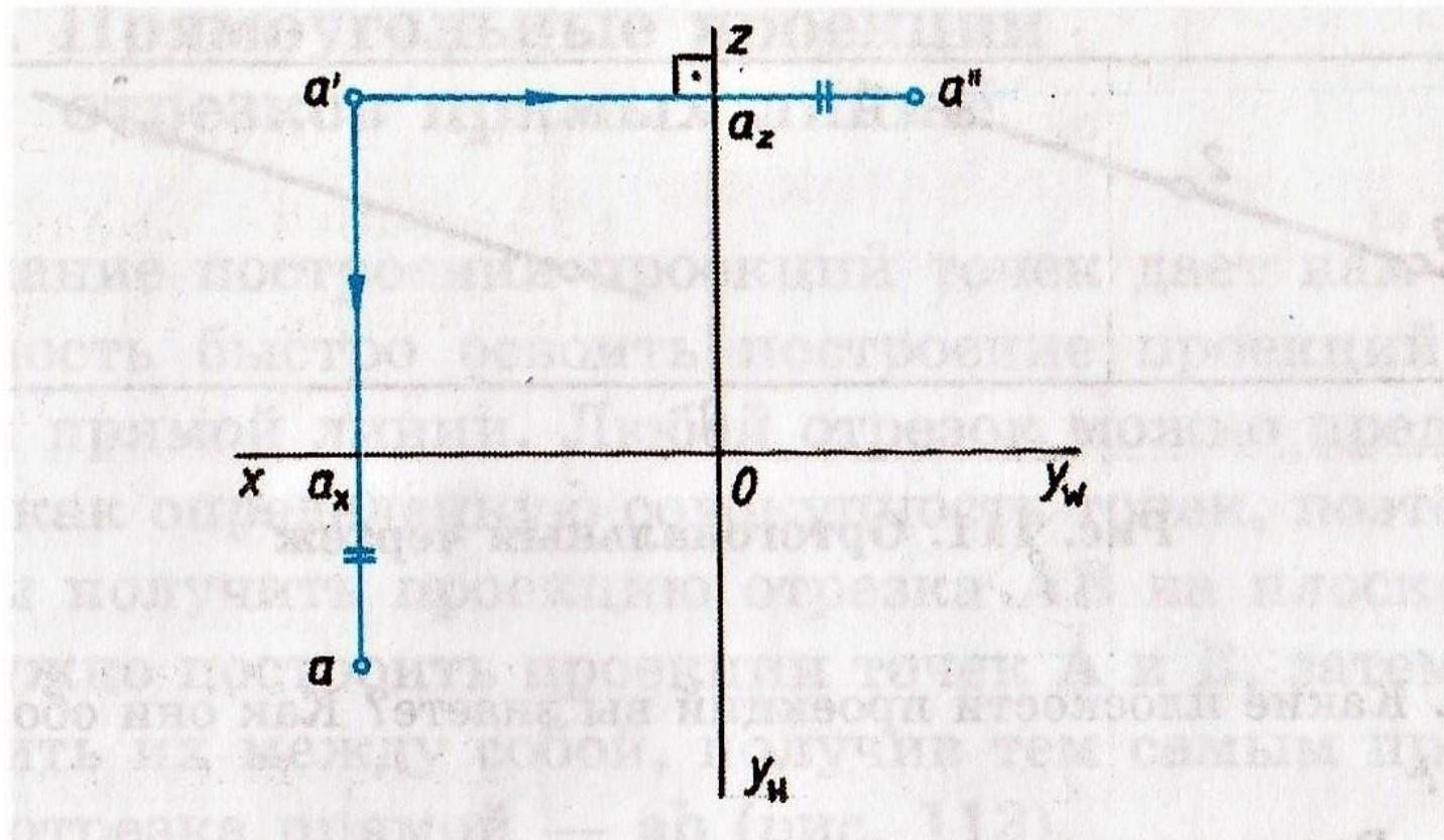
Построение третьей проекции точки по двум заданным с помощью постоянной прямой чертежа
