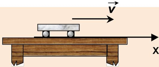
Тележка массой **0,1 кг** движется равномерно по столу со скоростью **5 м/с**, так как изображено на рисунке. Чему равен её импульс и как направлен вектор импульса?
