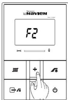
18. На экране LCD показать “F2” для настройки вентилятора времени зимнего режима.
