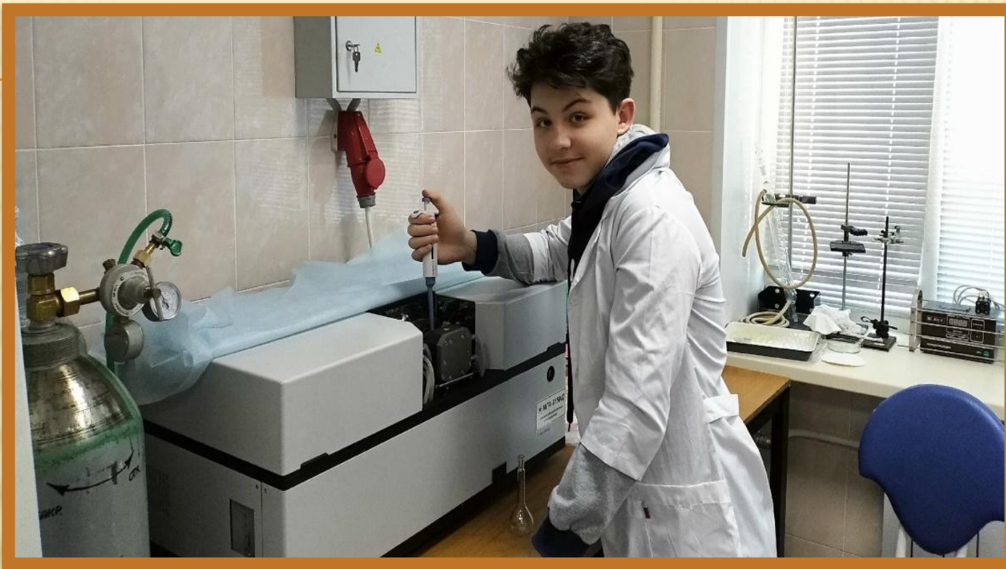
РИС.4. Ход работы по определению тяжелых металлов в почвах на атомно-абсорбционном спектрофотометре мга-915
