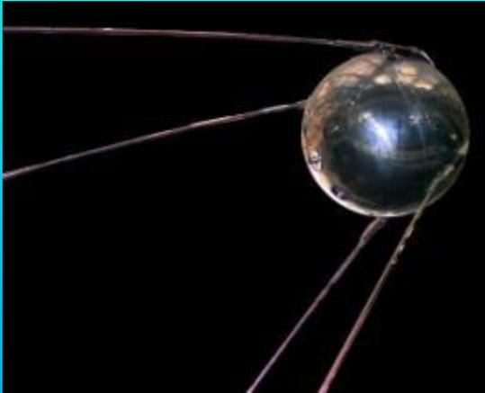
Спутник имел форму шара диаметром 58 см и весом 83,6 кг.
