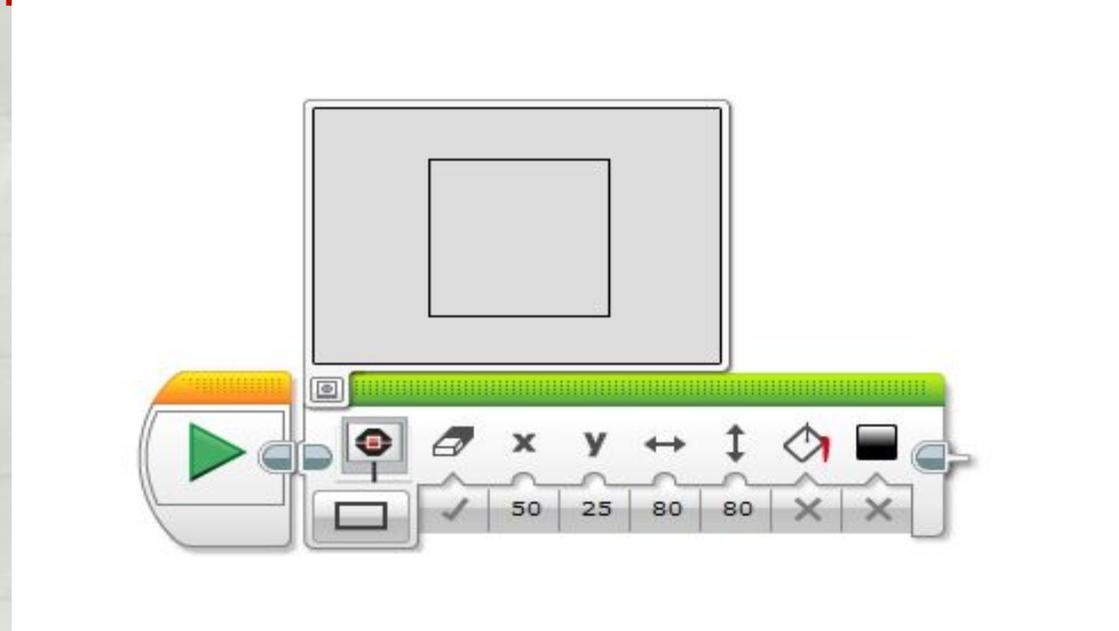
Вводы X1 и Y1 определяют экранные координаты первой точки линии, стрелки указывают на длину и ширину прямоугольника.
