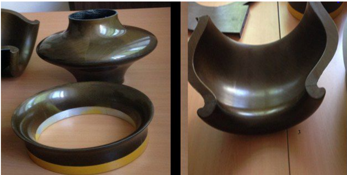
Рисунок 3 – Элементы ПЗУ изготовленные из углепластика ВКУ- 42
