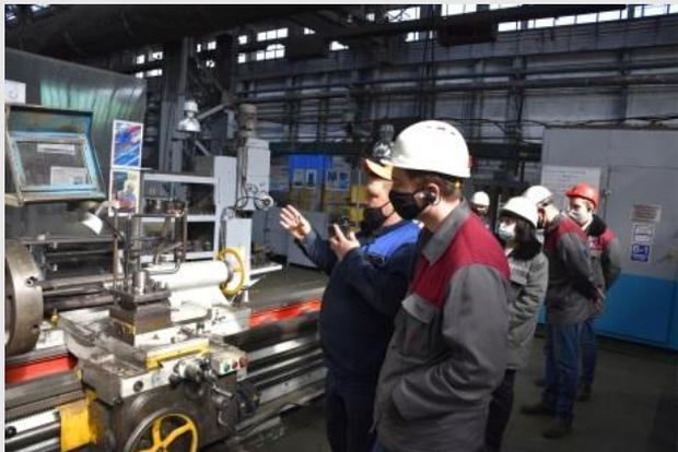
В рамках стандартизации рабочего места станочника широкого профиля (одно из мест, где произошел несчастный) реализованы улучшения в формате кайзен-предложений - изготовлены кожуха, конечные выключатели на 3 ед. оборудования. Стандартизация проходила в рамках двухнедельного обучения по производственной системе.
