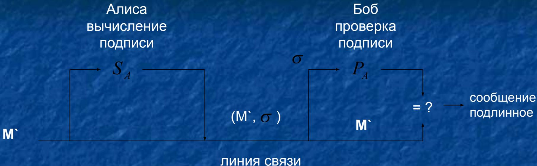
**Рис.** Цифровая подпись в системе с открытым ключом. Алиса подписывает свое сообщение  $M'$ , прикладывая к нему цифровую подпись  $\sigma = S_A(M')$ . Боб, получая от Алисы пару  $(M', \sigma)$ , проверяет соотношение  $M' = P_A(\sigma)$ . Если оно выполняется, подпись и само сообщение подлинны.
