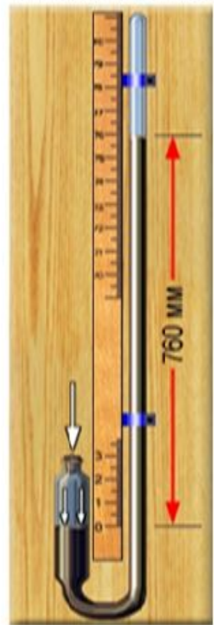
СХЕМАТИЧЕСКОЕ УСТРОЙСТВО РТУТНОГО БАРОМЕТРА
