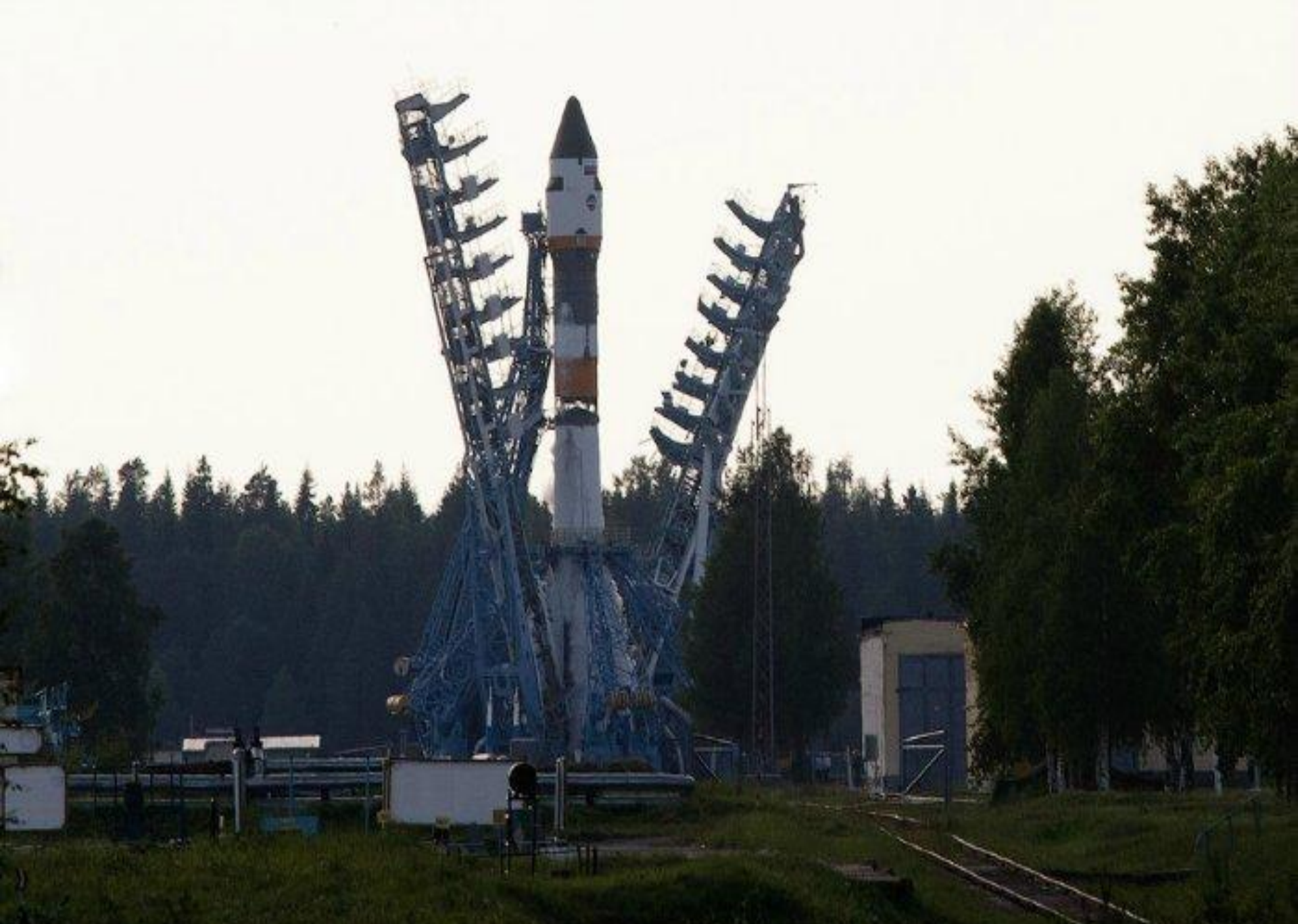
Первым делом опускаются главные стойки, и ракета остается висеть всего лишь на одной небольшой опоре, прикрепленной к носовой части.
