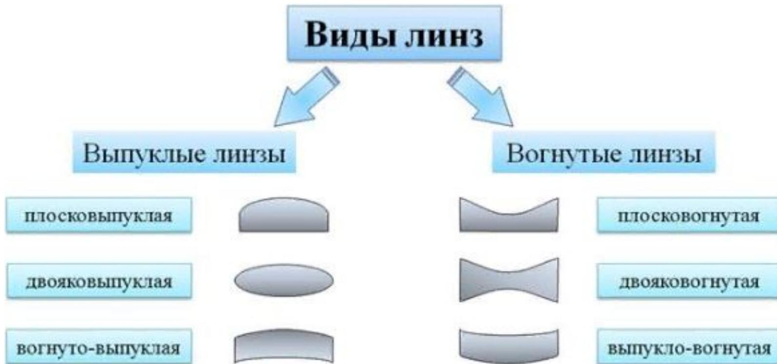
Любую выпуклую линзу можно представить в виде совокупностей плоскопараллельной стеклянной пластинки в центре линзы и усеченных призм, расширяющихся к середине линзы, а вогнутую — как совокупностей плоскопараллельной стеклянной пластинки в центре линзы и усеченных призм, расширяющихся к краям.
