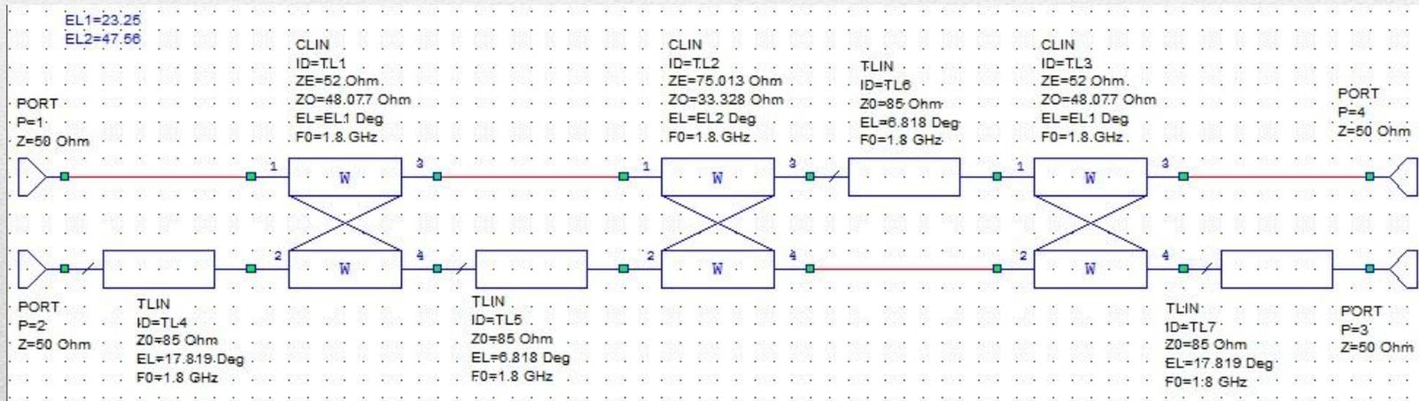
Рисунок 2 – Структурная схема НО в распределенном электрическом базисе
