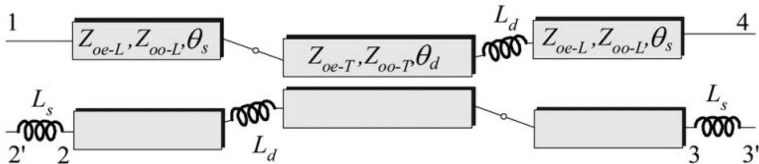
Рисунок 1 — Структурная схема компенсирующих индуктивностей для трехсекционного направленного ответвителя
