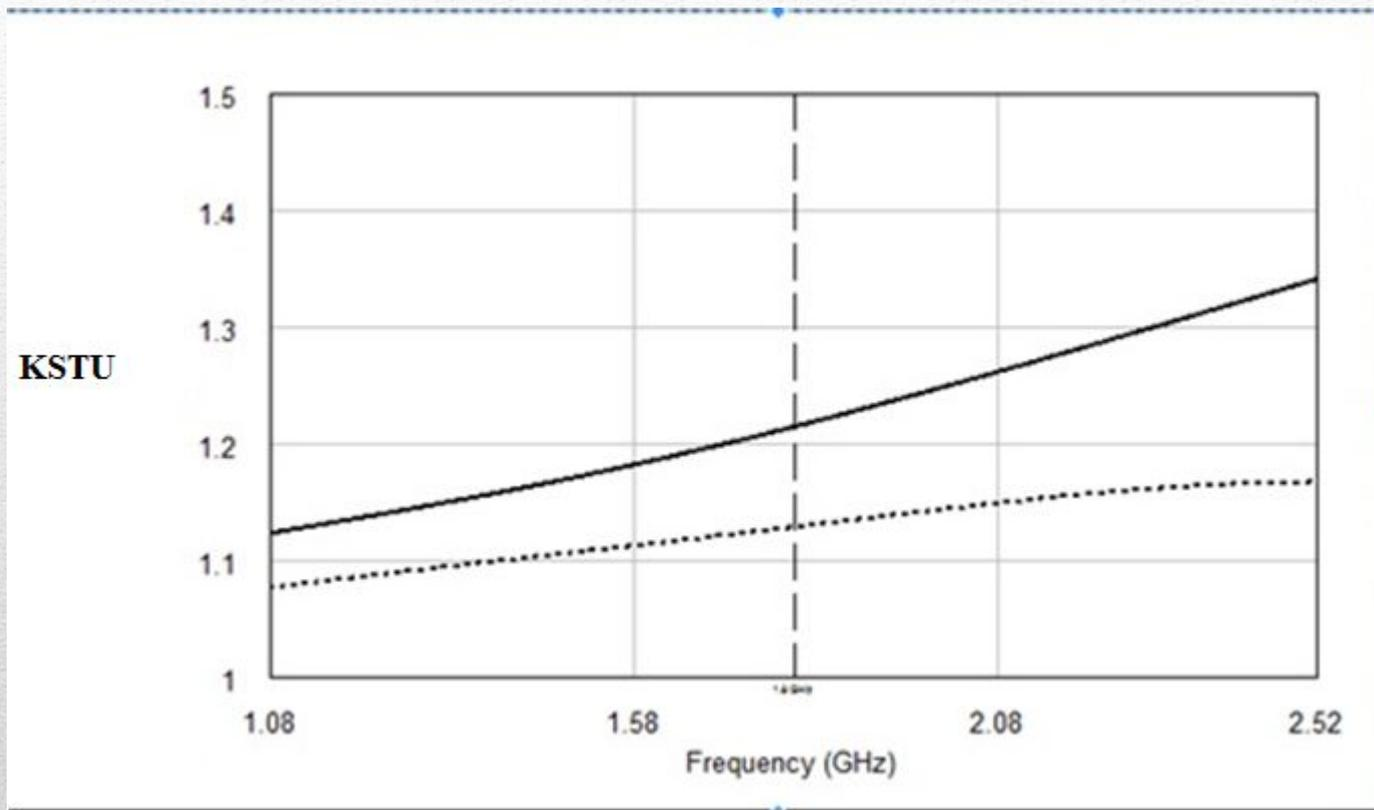
Рисунок 6 – Характеристика КСВН по входу НО в распределенном геометрическом базисе: с компенсирующими индуктивностями (—), без компенсации (---)
