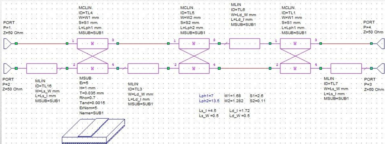
Рисунок 5 – Структурная схема НО в геометрическом распределенном базисе
