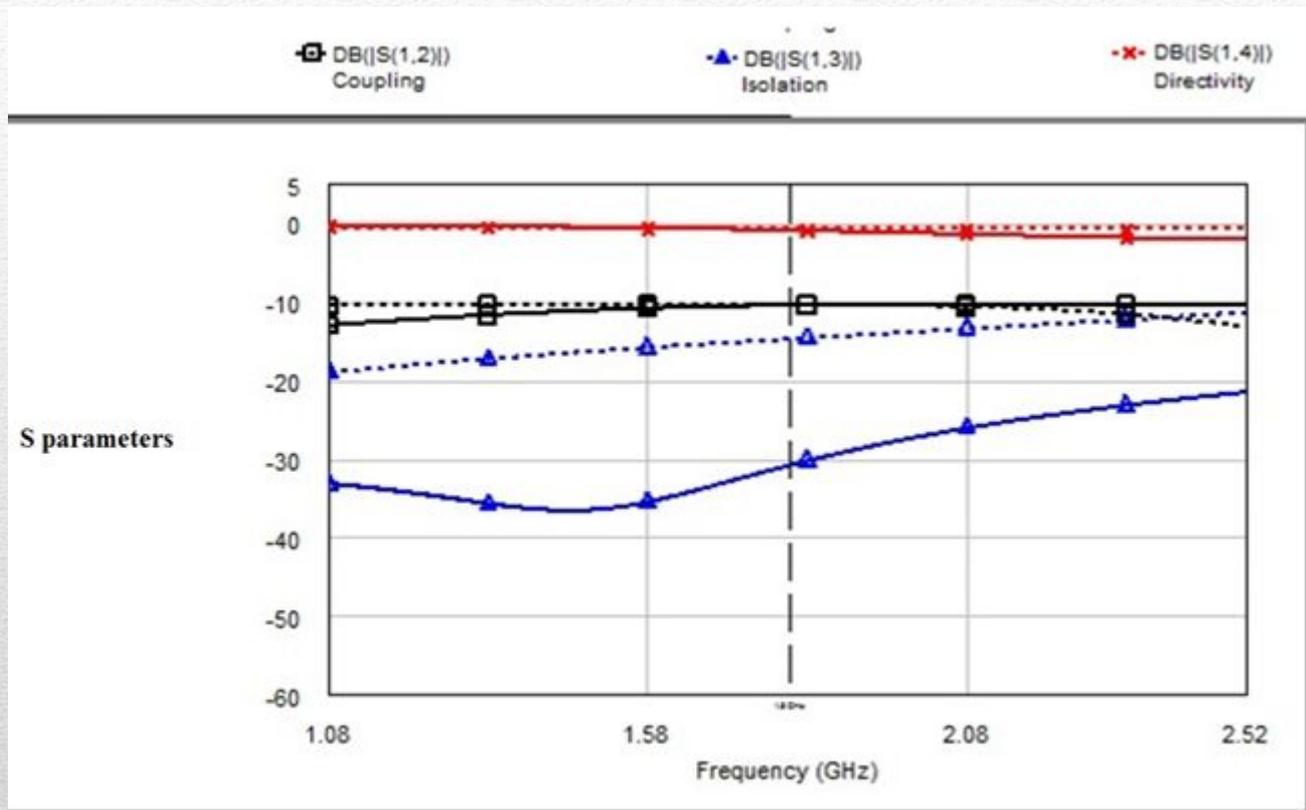
Рисунок 7 - S – параметры НО в распределенном геометрическом базисе: с компенсирующими индуктивностями (—), без компенсации (---)
