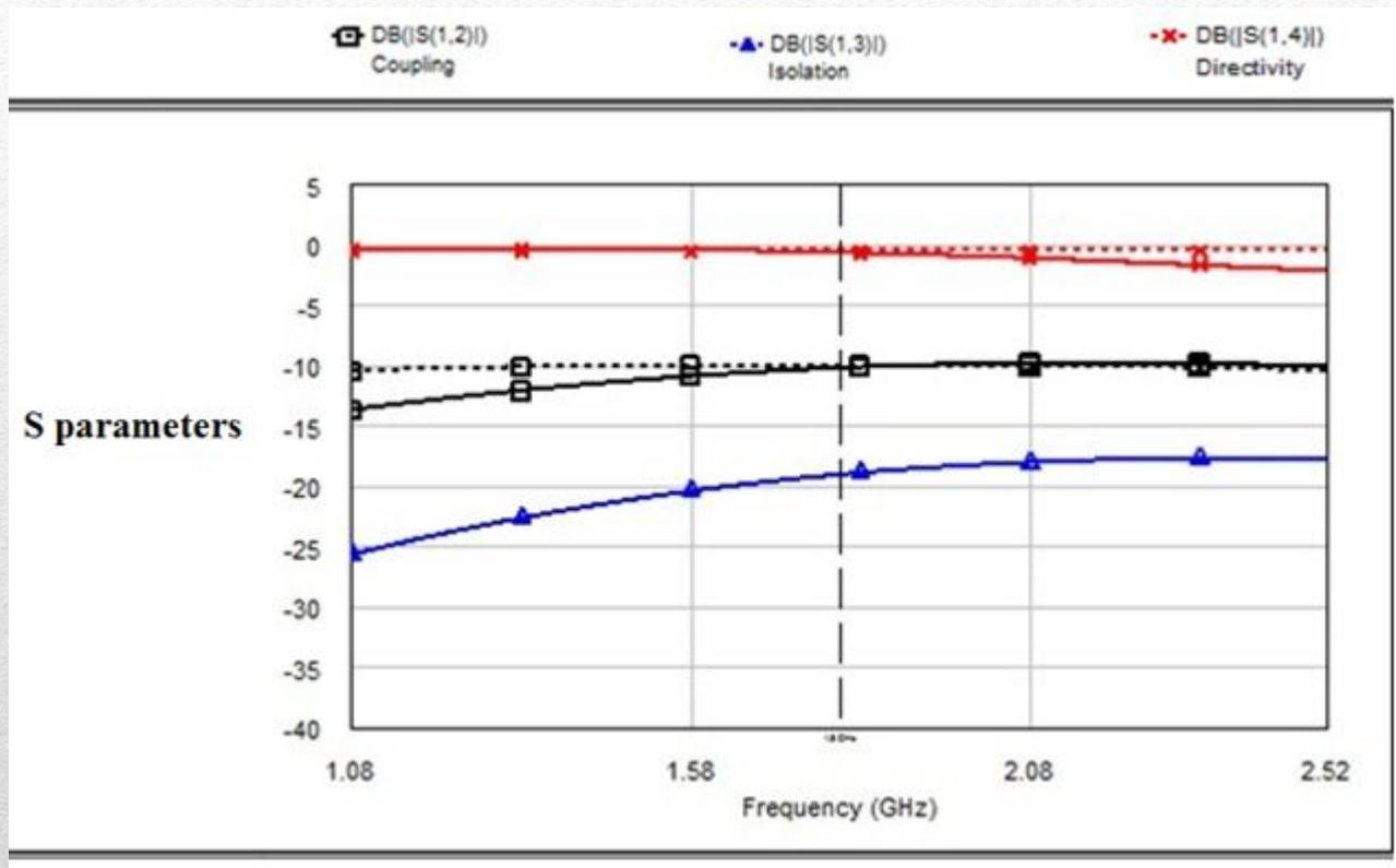
Рисунок 4 - S – параметры НО в распределенном электрическом базисе: с компенсирующими индуктивностями (—), без компенсации (---)
