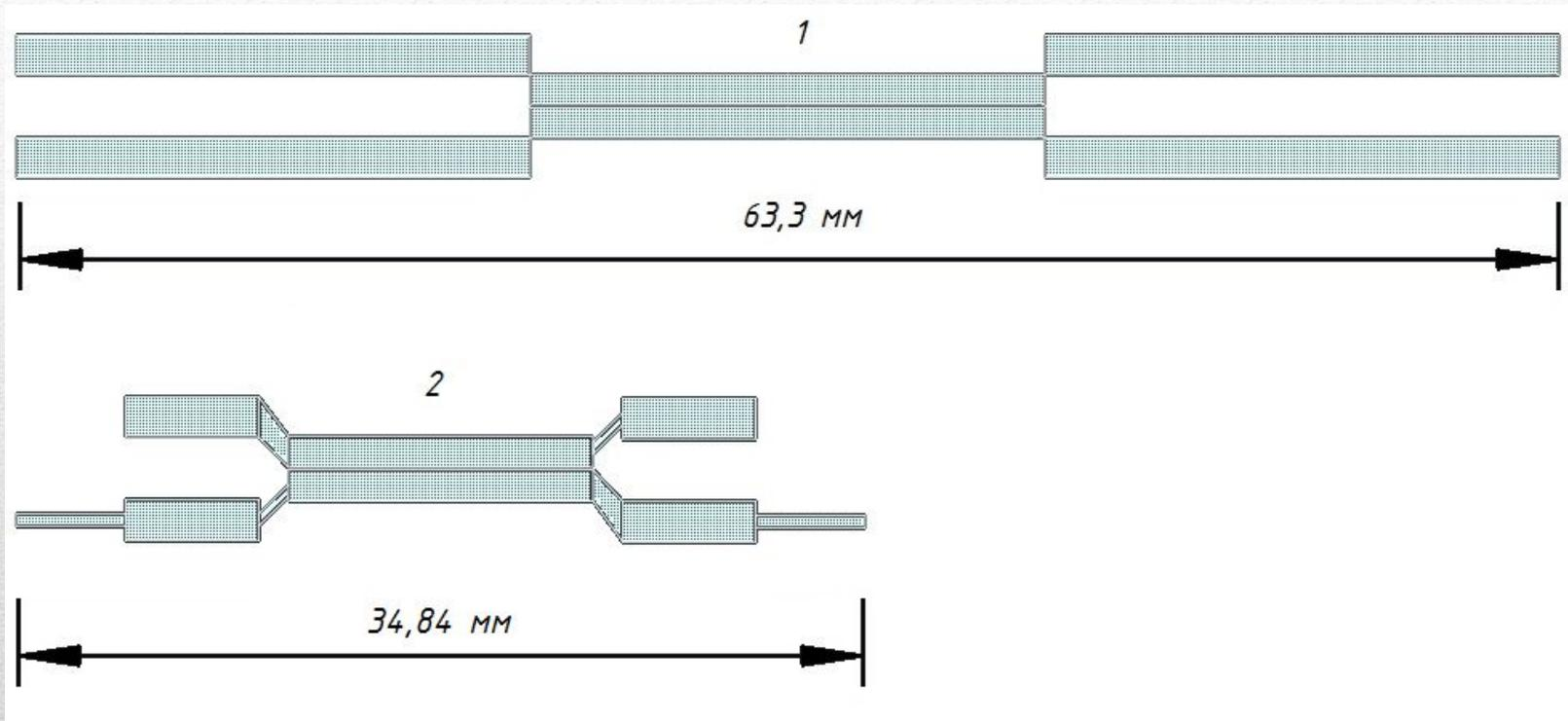
Рисунок 8 – Топология НО: 1). без улучшения характеристик, 2). с улучшенными характеристиками.
