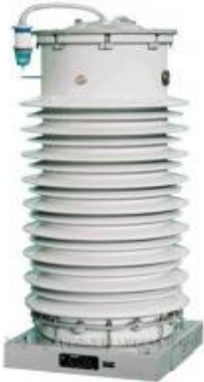
Однофазный, масляный, наружной установки, в фарфоровой крышке. Каждый блок трансформатора имеет свою активную часть и обмотки с электростатическими экранами. Опорой трансформатора (блока) является цоколь, на который монтируется активная часть и фарфоровая крышка. Цоколь имеет маслосливное устройство, коробку вторичных выводов, кабельную муфту. Магнитопровод изготовлен из пластин анизотропной, холоднокатаной электротехнической стали.
