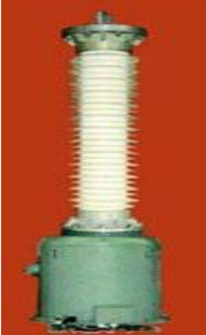
Внутренняя полость трансформатора заполняется элегазом, служащим изолирующей и теплоотводящей средой. Заполнение трансформатора элегазом производится через клапан, установленный на корпусе трансформатора. На корпусе трансформатора установлена предохранительная мембрана, срабатывающая при аварийном повышении внутреннего давления. Поток выхлопных газов направлен вниз, вдоль корпуса.
