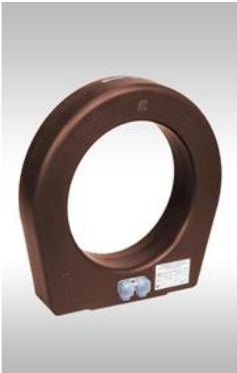
На большие номинальные первичные токи (6000-18000А) применяются ТТ, у которых роль первичной обмотки выполняет шина, проходящая внутри трансформатора. Эти трансформаторы представляют собой кольцеобразный эпоксидный блок с залитым в нем магнитопроводом и вторичными обмотками. Первичной обмоткой является шина токопровода.
