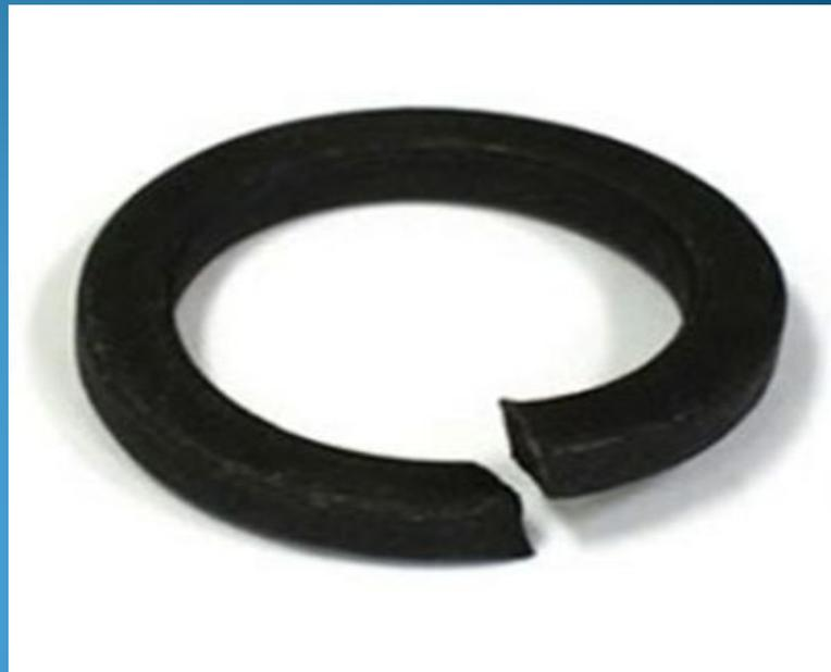
Основное предназначение крепёжной детали – предотвращение самопроизвольного откручивания деталей разъёмного соединения под воздействием динамических (циклических или ударных) нагрузок в процессе эксплуатации готовых изделий. Для этой цели гроверы подкладывают под головки винтов, болтов или между накручиваемой на них гайкой и плоской шайбой.
