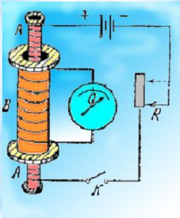
**ОПЫТ №3** Будем опускать в соленоид *B* катушку с током *A*. Оказывается, что и в этом случае в соленоиде *B* возникает индукционный ток только при относительном перемещении соленоида *B* и катушки *A*.
